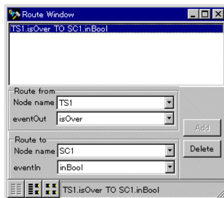
図 14 TouchSensor から Script へ Route の設定をする
