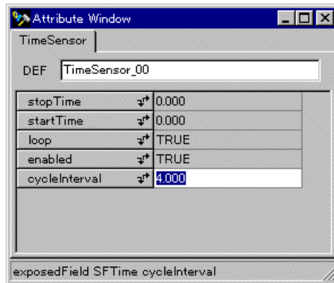
図 37 TimeSensor の cycleInterval フィールドでアニメーションの速度を変更する
